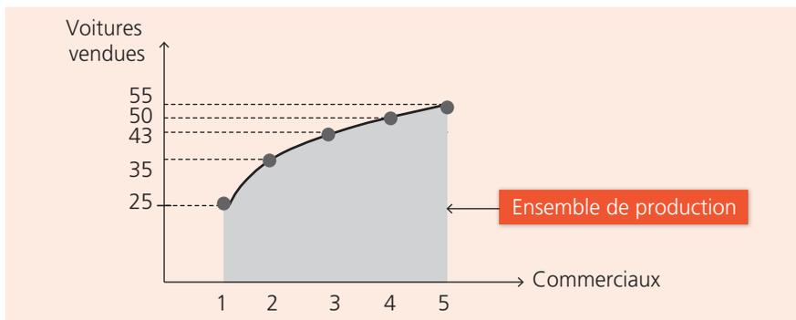
▲ **Figure 2.1** Fonction de production et ensemble de production d'une technologie à un facteur de production
